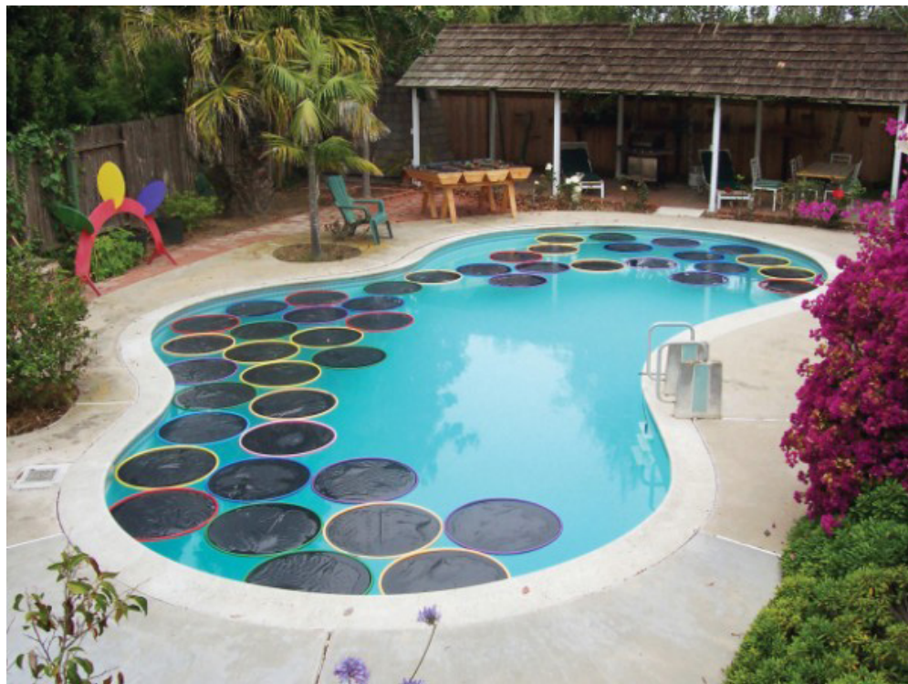
Slika 2. "DIY" rješenje zagrijavanja vode u bazenu pomoću energije Sunčeva zračenja
